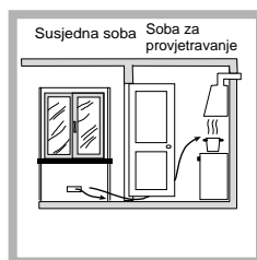
Povećanje ventilacijskog otvora između prozora i poda.
